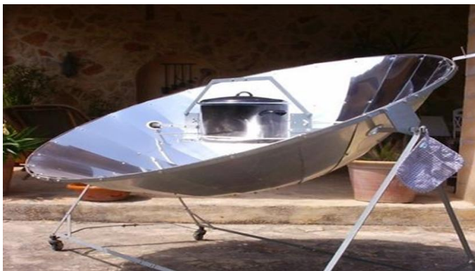
الشكل (2-30) طبق الطهي الشمسي (المجمع الحراري)
